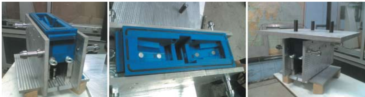
Сборная модельная оснастка для Лаэтре 20-40 — одноместный стержневой ящик для изготовления детали «башмак неповоротный» вагонной тележки
