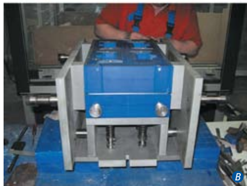
Процесс сборки стержневого ящика для Laempe 20-40 (четырёхместного) для изготовления стержней для детали «башмак тормозной» вагонной тележки: а — комплектующие детали; б — первоначальная сборка; в — пригонка формообразующих вкладышей; г — окончательная сборка
