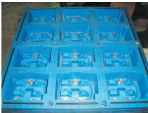
Двенадцатиместный стержневой ящик для Лаэтре 20-40 для детали «балочка» вагонной тележки. Показан один из трех ящиков, необходимых для изготовления данной детали
