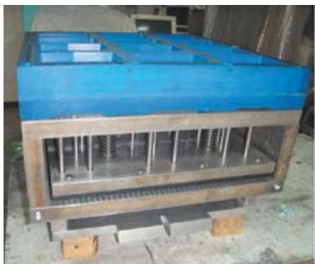
Двенадцатиместный стержневой ящик для Лаэтре 20-40 для детали «балочка» вагонной тележки. Показан один из трех ящиков, необходимых для изготовления данной детали
