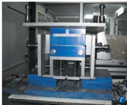
Процесс сборки стержневого ящика для Laempe 20-40 (четырёхместного) для изготовления стержней для детали «башмак тормозной» вагонной тележки: а — комплектующие детали; б — первоначальная сборка; в — пригонка формообразующих вкладышей; г — окончательная сборка
