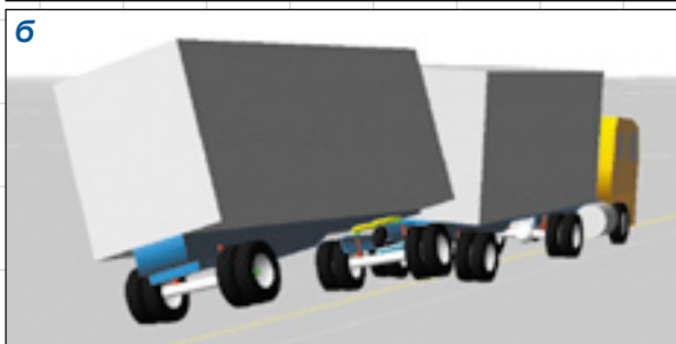
Рис. 1. Проведение некоторых натуральных экспериментов с автопоездом связано с опасностью его переворота и требует оснащения аутригерами: а — натуральный эксперимент; б — компьютерное моделирование (ил. взята из изд.: Winkler C.B., Blower D., Ervin R.D., Chalsani R.M. Rollover of Heavy Commercial Vehicles: SAE Research Report. Warrendale: Society of Automotive Engineers, Inc.)
